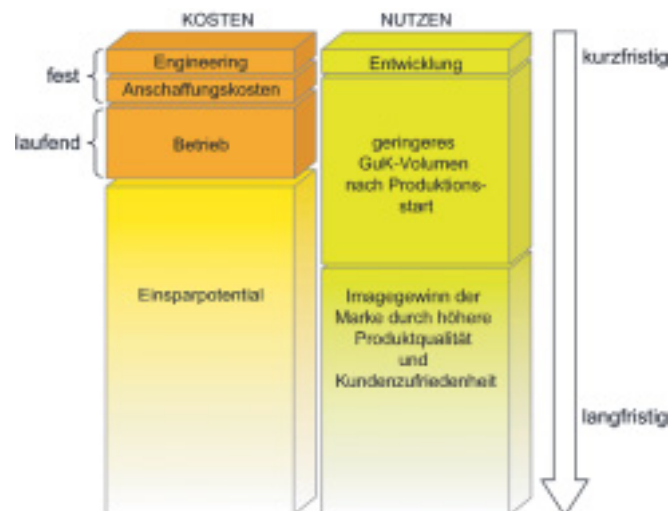
Bild 1: Neben entwicklungsbegleitenden Vorteilen bieten HIL-Prüfstände vor allem langfristige Einsparpotenziale
